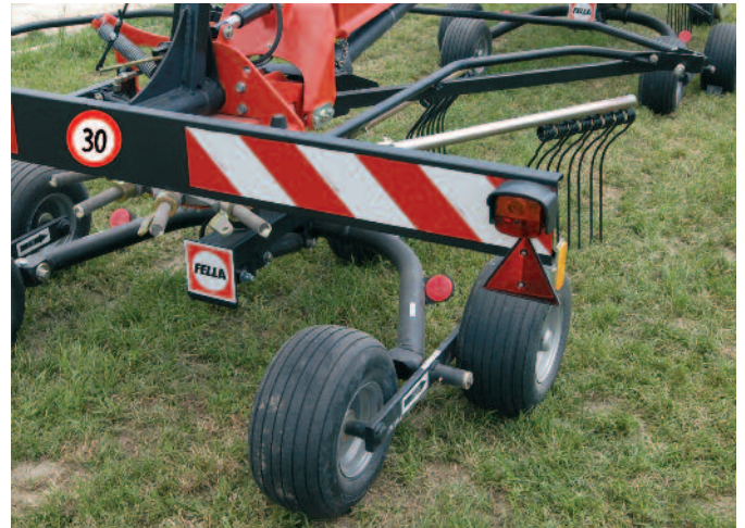
2 Die Konturen sind nicht leicht erkennbar. Es sind keine gefährlichen Teile vorhanden. Markierungstafeln sind erforderlich, Abdeckung ist nicht erforderlich.
