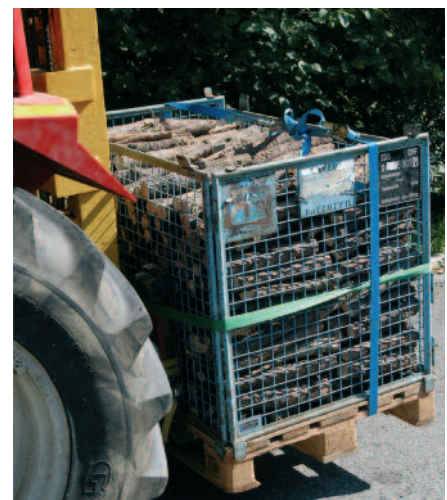
Werden Paletten mit dem Heckstapler transportiert, muss die Ladung gesichert sein.
