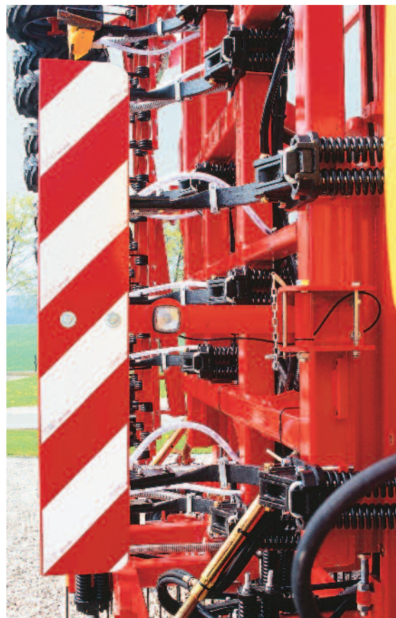
Abdeckung von Federzinken mit einem Winkelblech. Die angebrachte Markierungsfolie erhöht die Sichtbarkeit wesentlich.
