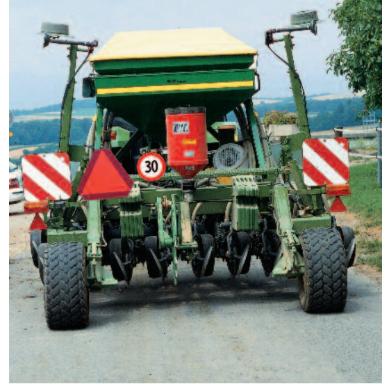
Das Anbringen von Markierungstafeln ist notwendig. In diesem Beispiel sind keine Abdeckungen von gefährlichen Fahrzeugteilen erforderlich. Vorne und hinten sind Rückstrahler erforderlich. Auch Lichter und Richtungsblinker sollten fest montiert sein.
