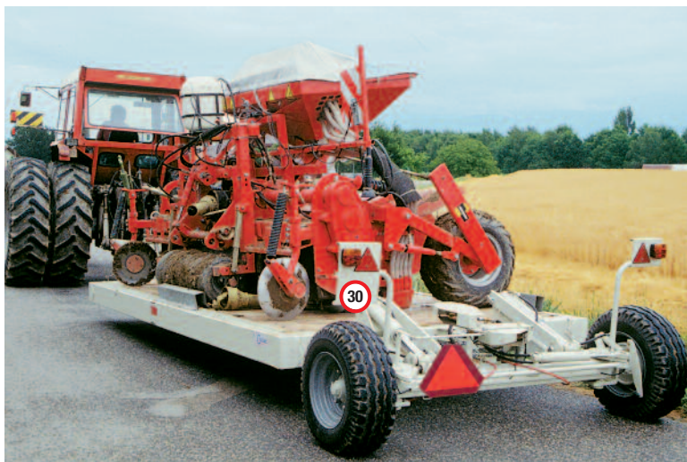
Anbaugeräte, die über 3,5 m breit sind, müssen längs transportiert oder verladen werden.
