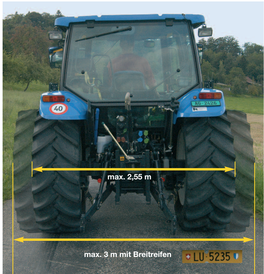
Die maximale Breite für landwirtschaftliche Motorfahrzeuge ist 2,55 m. Sie dürfen mit Breitreifen bis zur Breite von 3 m ausgerüstet werden. Solche Fahrzeuge sind landw. Ausnahmefahrzeuge mit braunen Kontrollschildern. Das Strassenverkehrsamt schreibt die erforderlichen Auflagen bezüglich Markierung und allenfalls zusätzlichen Beleuchtungsvorrichtungen und Rückstrahlern vor.
