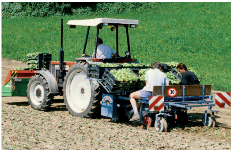
Markierungstafeln sind auf der Strasse erforderlich, Abdeckung nicht, sofern keine gefährlichen Teile vorstehen. Mitfahren auf der Strasse ist nicht erlaubt.
