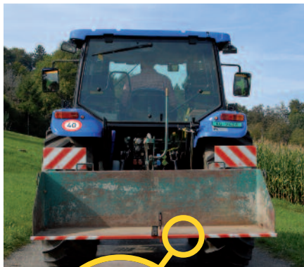
Für Ladeflächen mit Rückwand sind Beleuchtungsvorrichtungen und Rückstrahler, aber weder Markierungstafeln noch Abdeckung erforderlich.
