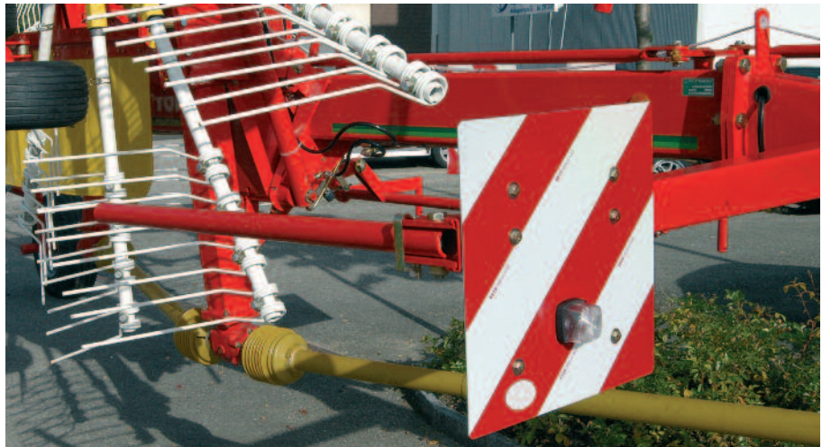
Die Verbesserung der Sichtbarkeit von landwirtschaftlichen Maschinen und Zusatzgeräten mit nicht leicht erkennbaren Konturen, hat oberste Priorität. Gefährliche Teile müssen abgedeckt oder mit Bügeln geschützt werden.
