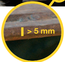
Kombischaufeln weisen Kanten von über 2,5 mm Radius oder 5 mm Ø auf (Bild links). Abgeschliffene Flächen können Schneiden aufweisen. Diese müssen abgedeckt werden.
