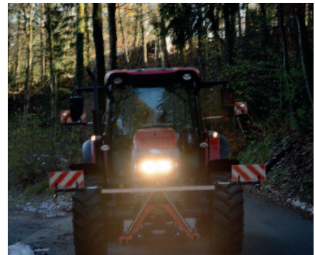
Seit 1.1.2014 gilt für landwirtschaftliche Fahrzeuge fahren mit «Licht am Tag», d.h. Abblendlicht einzuschalten oder Tagfahrlichter montieren.
