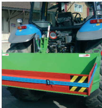
Kombischaufeln weisen Kanten von über 2,5 mm Radius oder 5 mm Ø auf (Bild links). Abgeschliffene Flächen können Schneiden aufweisen. Diese müssen abgedeckt werden.
