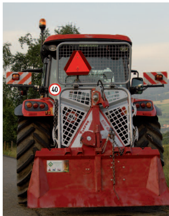
Mit Seilwinden sind Landwirte oft in der Dämmerung unterwegs. Eine gute Beleuchtung ist unerlässlich. Hier hilft die zusätzliche Beleuchtungseinrichtung des Traktors, die auch für die Doppelbereifung verwendbar ist.
