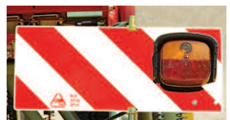
Markierungstafel mit Beleuchtungsvorrichtungen
