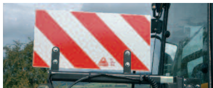
Es sind rot/weiss oder gelb/schwarz gestreifte Markierungstafeln erlaubt. Retroreflektierende Markierungen erhöhen die Sichtbarkeit deutlich.
