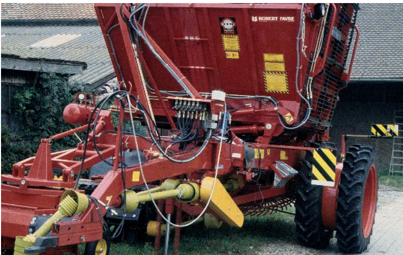
Das Anbringen von Markierungstafeln ist notwendig. Zusätzliche Abdeckungen von gefährlichen Fahrzeugteilen sind bei diesem Anhänger nicht notwendig. Vorne und hinten sind Rückstrahler erforderlich. Lichter und Richtungsblinker sollten fest montiert sein.
