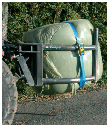
Mit geeigneten Transportgeräten darf am Heck eine gesicherte Grossballen transportiert werden.
