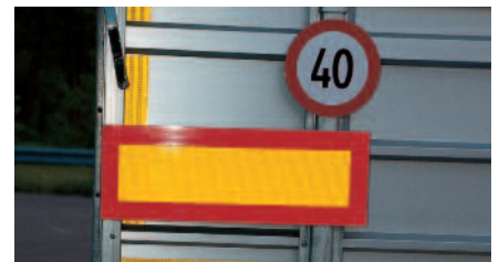
Zusätzlich erlaubte Heckmarkierungstafel für Anhänger über 30 km/h
