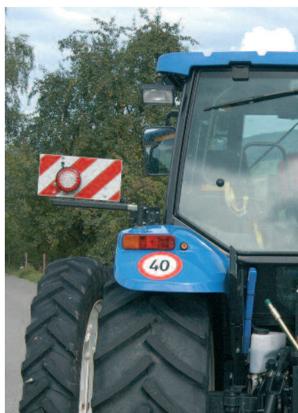
Landwirtschaftliche Motorfahrzeuge dürfen bis zu einer Breite von 3 m mit vorübergehend erforderlichen Doppelrädern ausgerüstet werden. Die Fahrzeugbreite muss tags mit Markierungstafeln, nachts und bei schlechter Witterung mit Markierlichtern gekennzeichnet werden. Es wird empfohlen, die Markierungstafeln und Markierlichter am Traktor fest, beziehungsweise auszieh- und/oder klappbar anzubringen.
