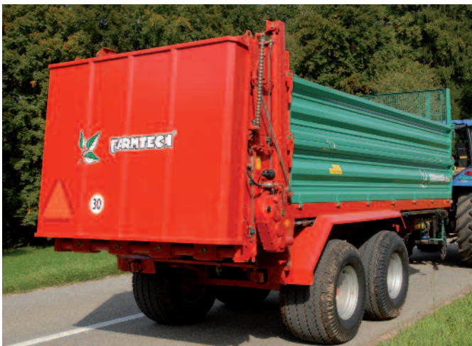
3 Die Konturen sind leicht erkennbar. Streuwalzen sind gefährliche Teile. Markierungstafeln sind nicht nötig. Streuwalzen müssen abgedeckt werden.
